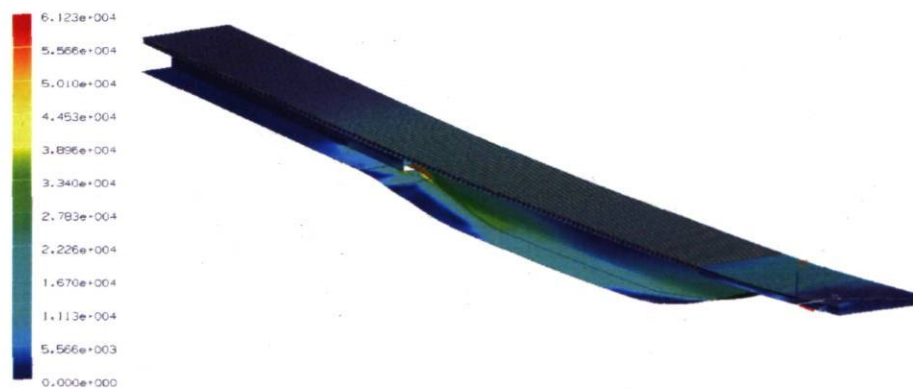
Figure 5.9 : Résultat d'analyse de la coque sans renfort
