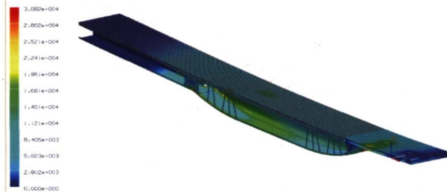
Figure 5.10 : Résultats d'analyse de la coque renforcée des supports verticaux
