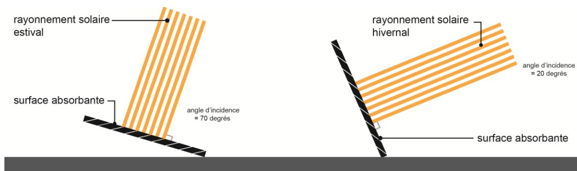
Figure 13 : Représentations schématiques d'une surface absorbante perpendiculaire au rayonnement solaire, en été et en hiver pour la latitude 46^{\circ} 48'' N.
