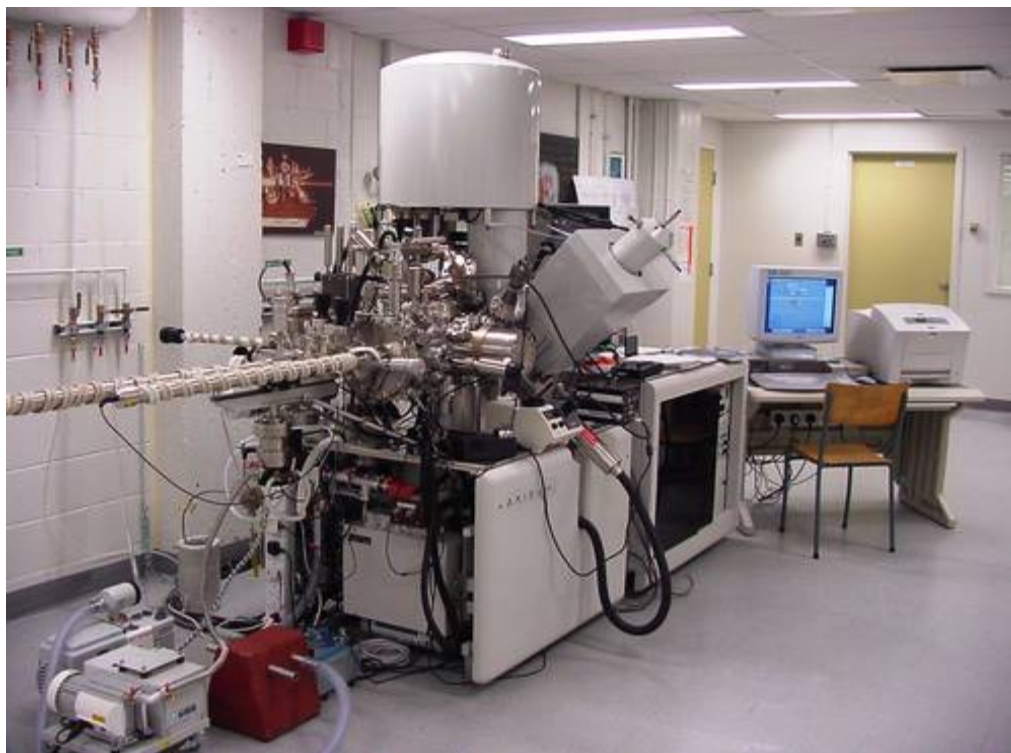
Figure 2.28 Spectromètre AXIS-ULTRA (Kratos UK) pour l'analyse chimique XPS.
