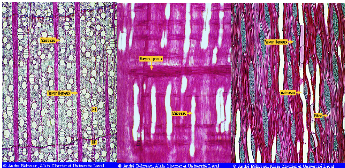
Figure 2.1 Photomicrographies d'érable à sucre. De gauche à droite : plan de coupe RT, RL et LT (Grossissement de 40x) ©André Béliveau, Alain Cloutier et Université Laval.
