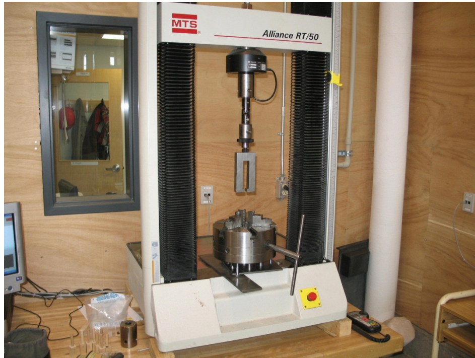
Figure 2.7 Montage pour les essais mécaniques préliminaires en traction linéaire.
