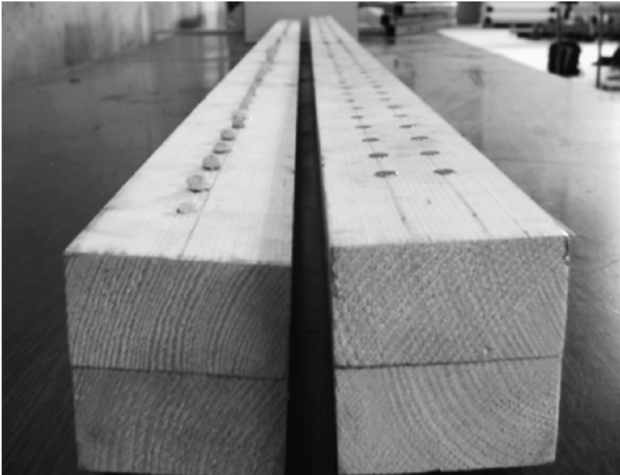
Figure 1.32 Assemblage soudé (gauche) et assemblage cloué (droite) en prévision d'essais en flexion (Bocquet et al. 2007).
