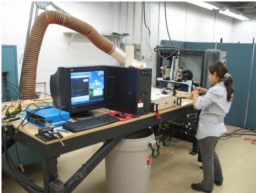
Figure 2.11 Montage pour les essais de détermination de la température à l'interface de soudage.
