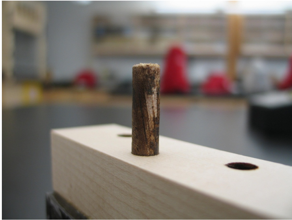
Figure 2.20 Arrachement de fibre sur un goujon suite à un essai en traction. Assemblage soudé d'érable à sucre avec insertion en alternance des goujons.
