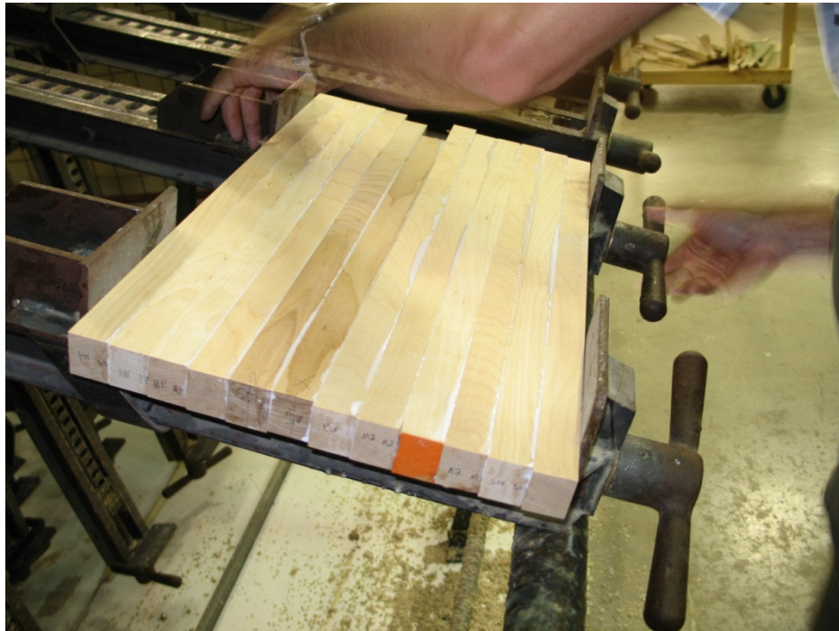
Figure 2.25 Insertion d'un panneau lamellé-collé dans une serre une fois l'application de l'adhésif effectuée.
