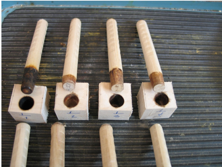
Figure 2.9 Exemples de goujonnage inadéquats: interface de soudage fortement carbonisée (goujon à l'extrême gauche); insertion incomplète en raison de paramètres de soudage inadéquats (2 e goujon en partant de la gauche).
