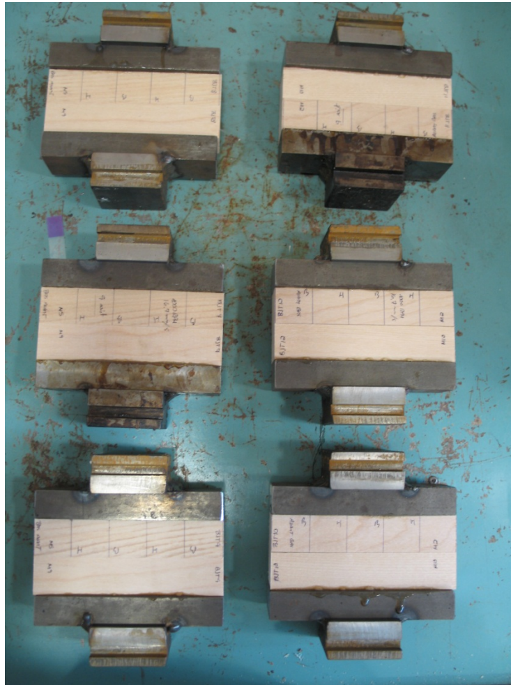
Figure 2.15 Éprouvettes pour les essais en traction linéaire d'assemblages soudés.
