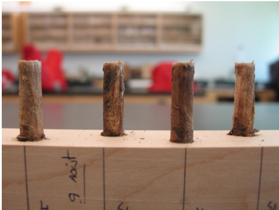
Figure 2.19 Vue rapprochée d'une section d'assemblage soudé de bouleau jaune avec insertion unidirectionnelle des goujons suite à un essai en traction linéaire.
